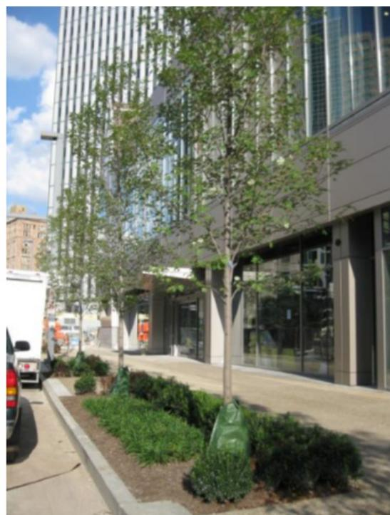
Figures 5 et 6: Arbres de pluie implantés sur le Boulevard de Berlaymont à Bruxelles, les eaux de pluie et de ruissellement sont collectées via un petit canal, implanté sur le trottoir et qui relie l'ensemble des arbres sur un alignement continu. Source: Architecture et Climat
